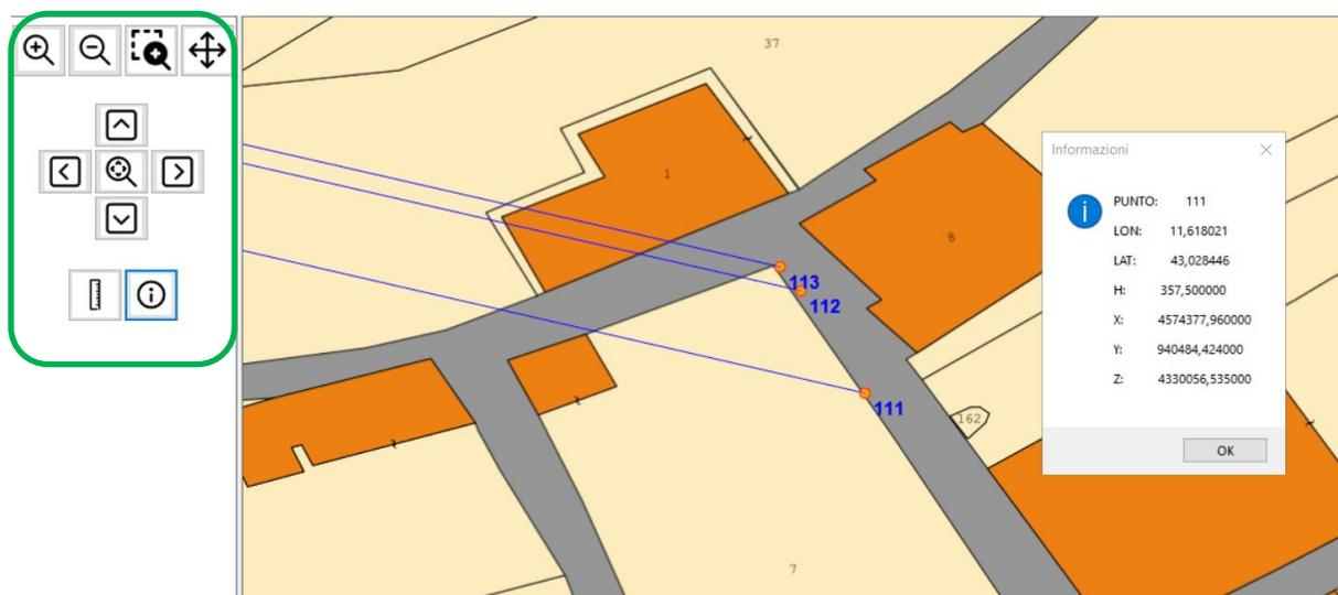
Figura 60 – Sovrapposizione rilievo cartografia catastale WMS
